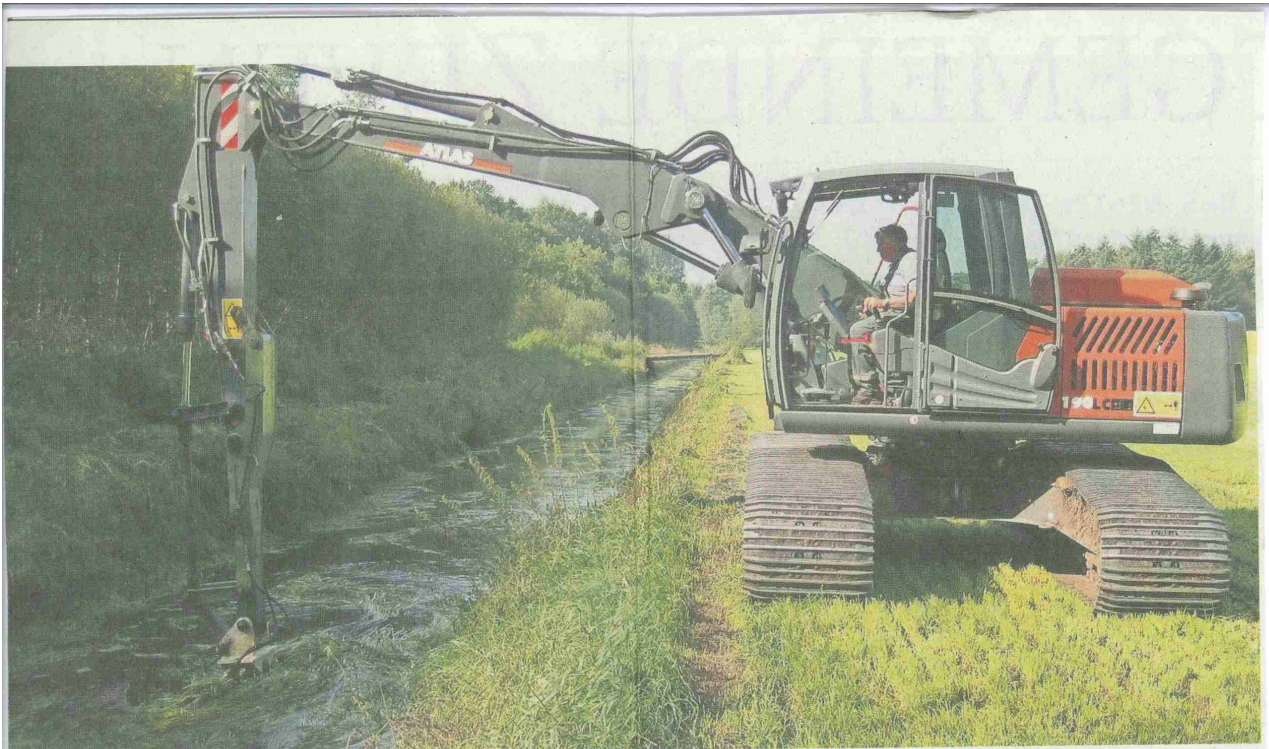
Die Räumbagger müssen gut an die Wasserläufe kommen. Dafür ist ein fünf Meter breiter Streifen an den Gewässern frei zu halten.
